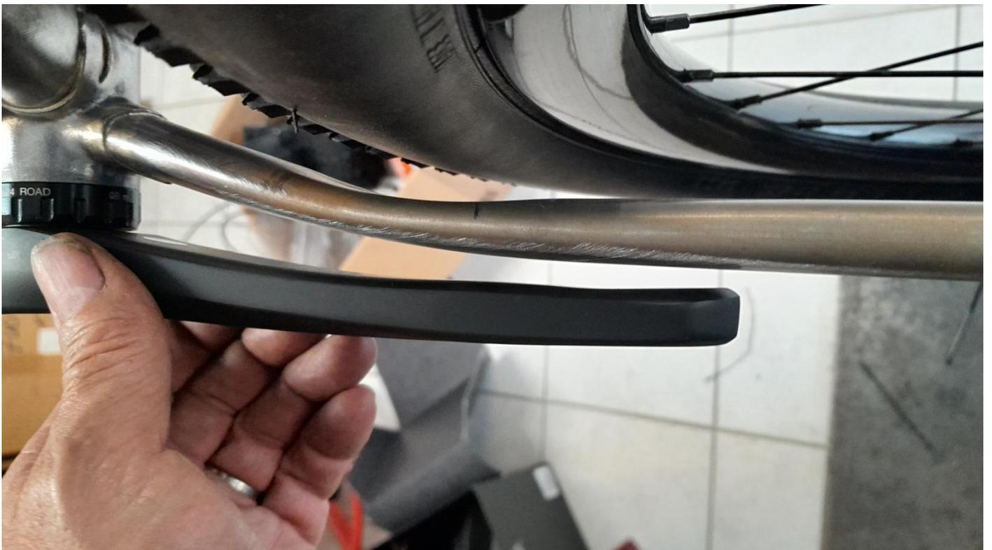
Contrôle du passage des pneus en 2,2 et des manivelles gravel GRX à Q factor assez serré.
